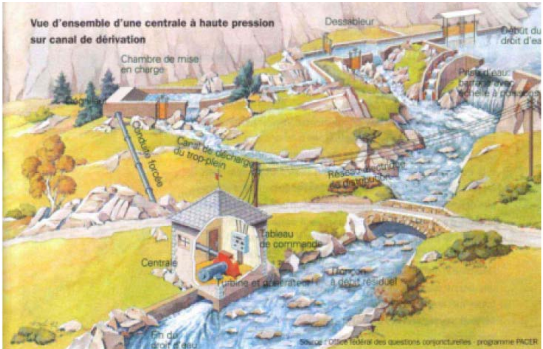
Schéma d'implantation d'une petite centrale hydraulique sur canal de dérivation
